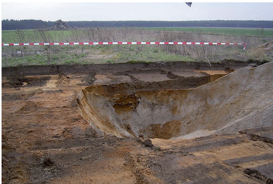
Vorbereitung einer amtlichen Probenahme mittels Baggerschurf, Erweiterung Kiessandtagebau Laußig -Nord (Foto: Landesamt für Umwelt und Geologie)
