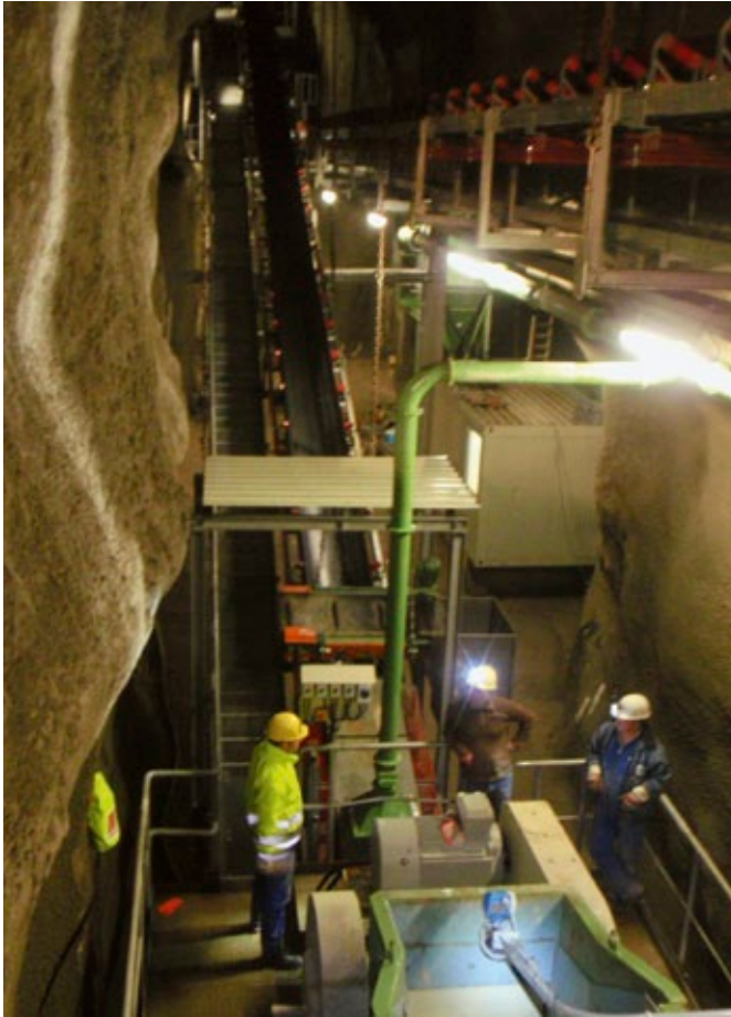
Spatgrube Niederschlag, Betriebseinrichtung zur Aufbereitung unter Tage – Röntgensortieranlage
