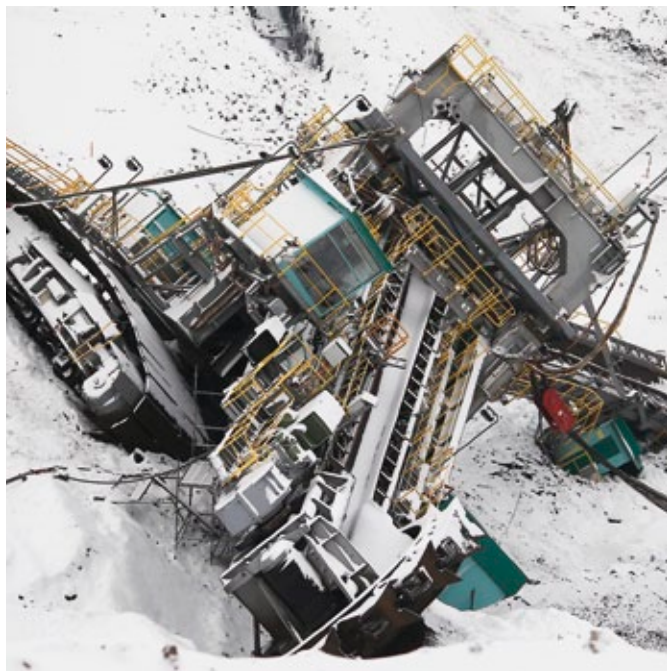
Tagebau Vereinigtes Schleenhain – Bergung des Baggers 1554 nach dem geotechnischen Ereignis vom 29. August 2012
