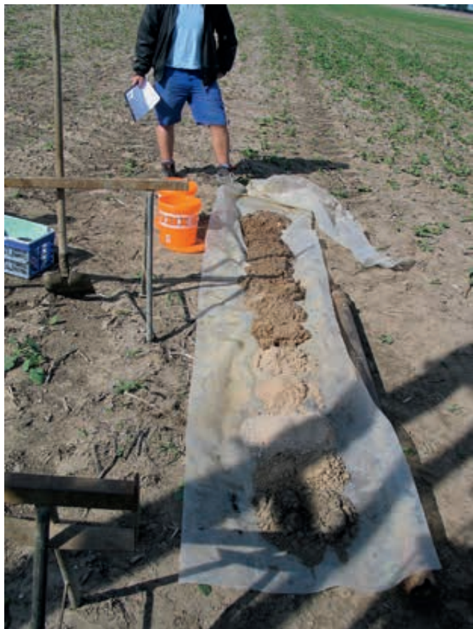
Amtliche Beprobung von ausgelegtem Bohrgut (Terrassenschotter aus Nordsachsen) zur Bestimmung der Bodenschatzkategorie
